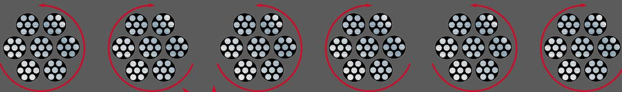
Das Außenmaterial des CONTI POLYFLAT® PU-Flachriemens besteht aus Polyurethan; der Zugträger aus einer Litzenkonstruktion. Die beiden gegenläufigen Schlagrichtungen der Stahlcorde und ihrer Litzen bewirken ein neutrales Laufverhalten.
